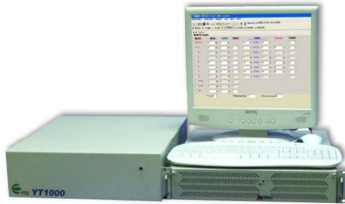
YT1002 是一台高品質高功能的 LED 測試機，具有 LED 元件光學量測、電氣特性量測及測試資料統計分析等功能。波長的量測範圍為 350~1000nm 適用於藍光、綠光、紅光、白光 LED 及 IR 量測，提供 2 組 15V~-40V/1.8A 的 HCPMU，及 2 組 3mA 的 LMU DC 量測單元，適用於單晶及高亮度的白光 LED 量測，同時也提供 1 組 -2000V/1.3A ESD 量測單元，量測 LED ESD 功能。整合各式光譜卡、分光器及積分球並可連接各種 Prober 及 Handler 用於不同製程量產測試使用，完善的量產測試統計報表及分析工具，作為量產管理及品質改善使用。
