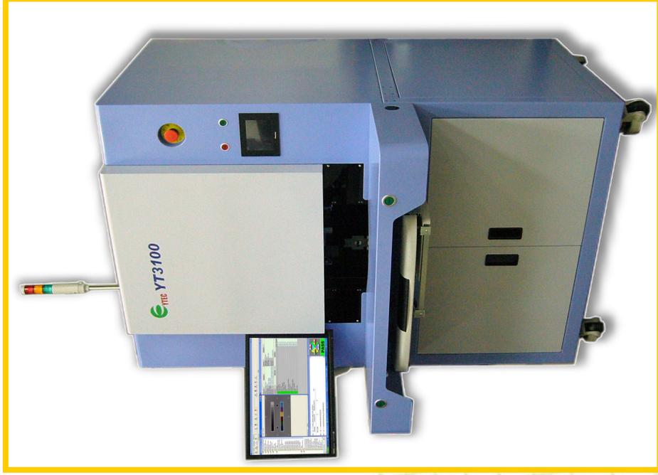
全自動影像感測模組測試設備
